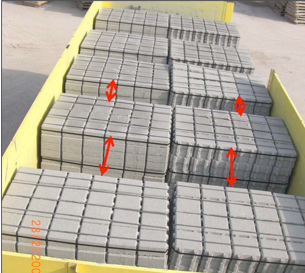
Bild 1: Anordnung von Ladeeinheiten aus Betonpflastersteinen „auf Lücke“ in Fahrtrichtung
