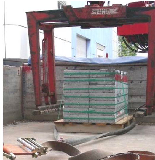
Bild 4: Klammergreifer am fahrzeuggebundenen Kran zur Be- und Entladung von paketierten Betonwaren
