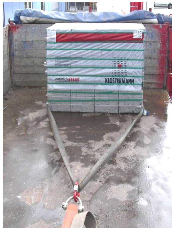
Bild 7: Zugkraftmessung zur Bestimmung des Gleit-Reibbeiwertes zwischen nicht palettierter Ladeinheit und Ladefläche mit Stahlboden (nach Regenschauer)
