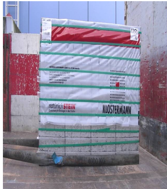
Bild 6: Zugkraftmessung zur Bestimmung des Gleit-Reibbeiwertes zwischen nicht palettierter Ladeinheit und Ladefläche mit Siebdruckboden
