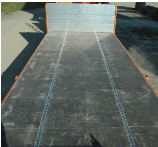
Bild 8: Siebdruck-Fahrzeughöden mit deutlichen Gebrauchsspuren (hier: nach einwöchiger Nutzungsdauer)
