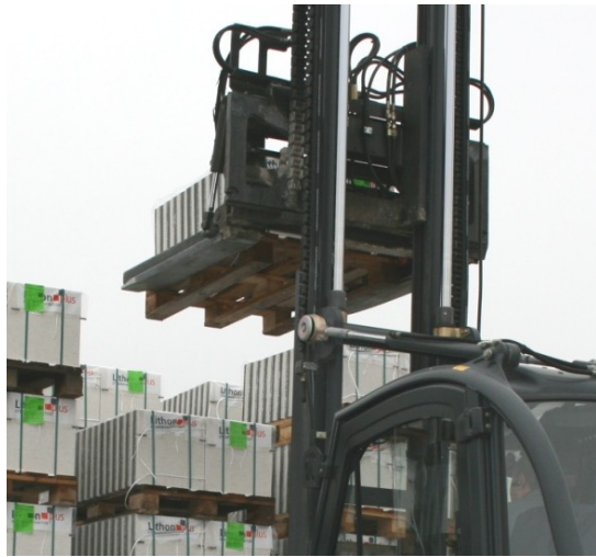
Bild 3: Klammergreifer am Stapler zum Umschlag und zur Beladung von paketierten Betonwaren im Werk
