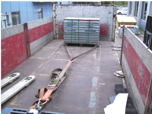
Bild 5: Zugkraftmessung zur Bestimmung des Gleit-Reibbeiwertes zwischen palettierter Ladeinheit und Ladefläche mit Siebdruckboden
