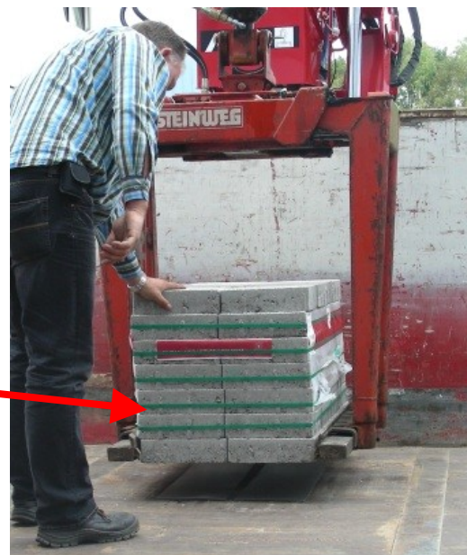
Bild 10: Beispiel für eine Anwendung von rutschhemmenden Materialien (RhM) unter einem Pflastersteinpaket
