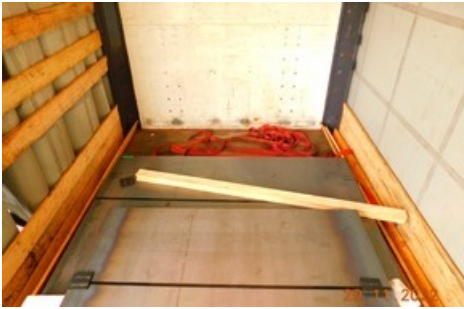
erhebliche Ladelücke zur Stirnwand des Aufliegers
