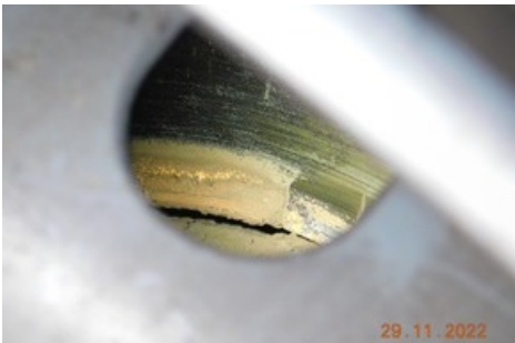
beschädigte Bremsscheibe des Aufliegers
