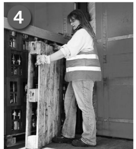
4 Sichern: Die Fahrerin stellt Leerpalletten senkrecht gegen die Getränkekästen, um diese vor den Fässern zu schützen.
