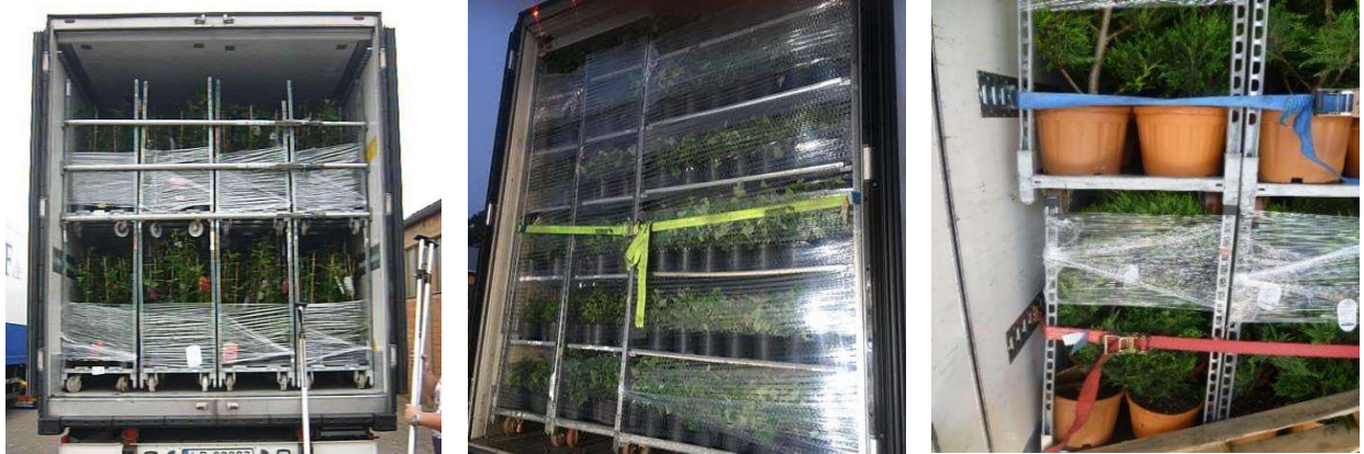
Bild 7 bis 9: Beispiele aktuell praktizierter Maßnahmen zur Sicherung der Ladung in Fahrtrichtung, hier: Verwendung horizontaler Klemmstangen und Zurrgurte
