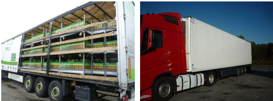
Bild 14 und 15: Fahrzeugaufbau links mit Schiebeplane (Curtainsider) und Einstecklatten sowie rechts mit Kofferaufbau
