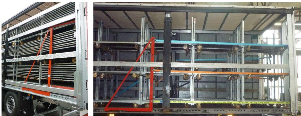
Bild 17 und 18: Ständer links und mit angehängten Zurrmitteln rechts montiert im Stahlrahmen auf Lochschiene am Fahrzeugrahmen bei einem Curtainsider-Aufbau (Seitenansicht)
