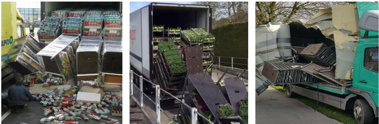
Bild 4 bis 6: Schäden durch Verrollen von CC-Containern in Richtung des Fahrzeughecks bzw. der Fahrzeugseitenwand
