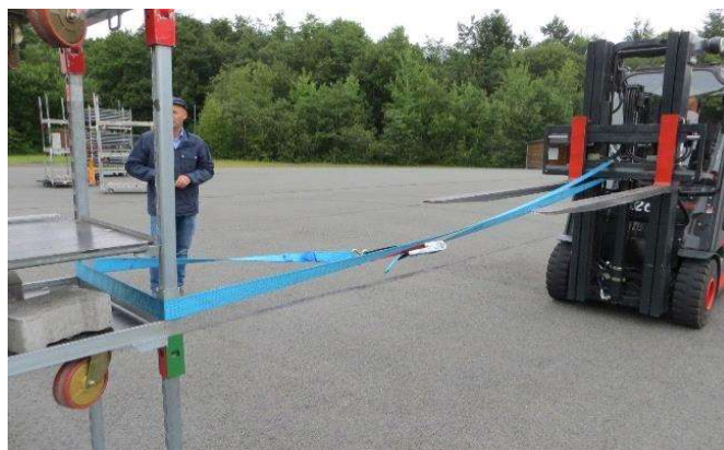
Bild 25: Zugversuche an einem Stapel aus CC-Containern mit CC-Hülsen als Verbindungselement. Simulation der Belastung beim „beidhändigen Ziehen“ der gestapelten Container „per Hand“
