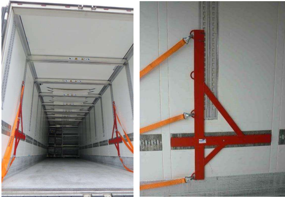
Bild 16 und 17: Ständer aus Stahl mit Anschlagösen für Zurrgurte, jeweils rechts und links verschraubt in der Seitenwand eines Kofferaufbaus
