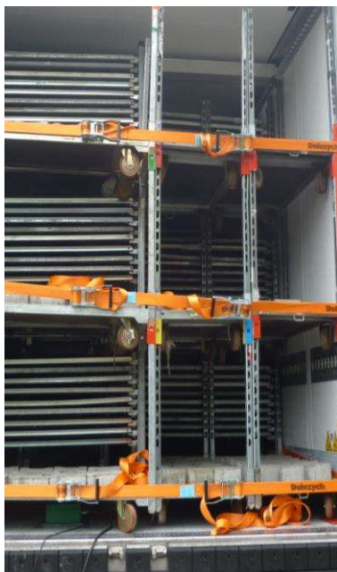
Bild 19 (links): Vertikal Eckpfosten (hier weiß) mit Führungen für Zurrmittel
