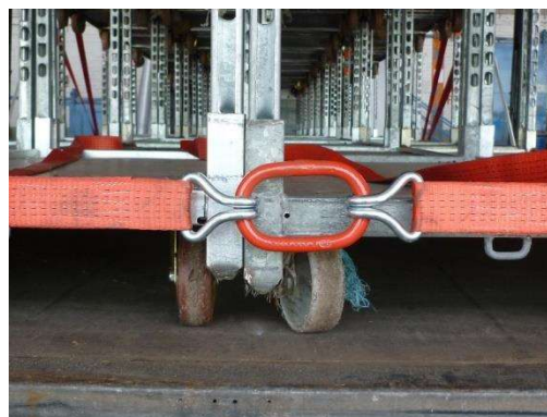
Bild 19 (links): Vertikal Eckpfosten (hier weiß) mit Führungen für Zurrmittel
