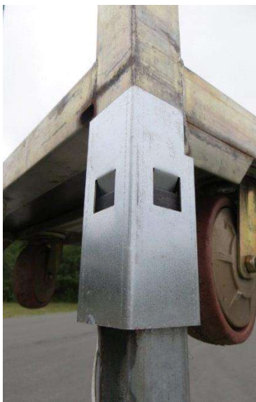
Bild 22 und 23: CC-Hülse aus verzinktem Stahlblech (links) bzw. aus Kunststoff (rechts)
