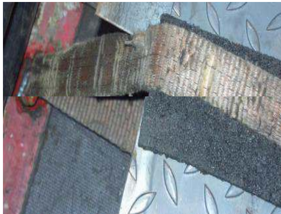
Abb. 31: Ablegereifer Gurt mit Antirutschmatte als Kantenschutz
