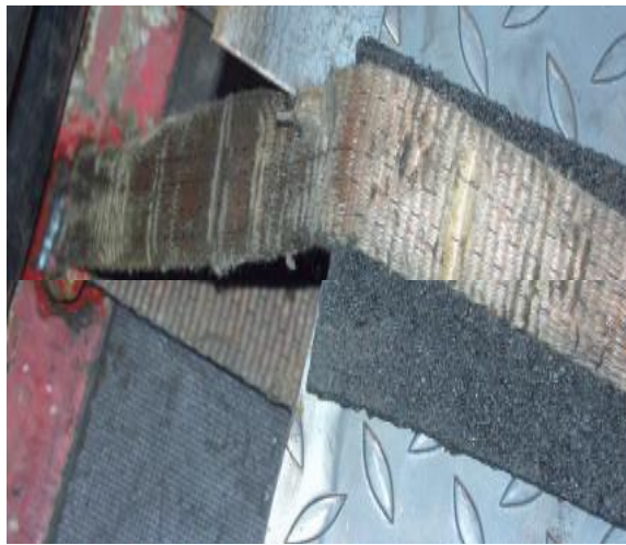
Abb. 30: Ablegereifer Zurrgurt mit Antirutschmatte als Kantenschutz
