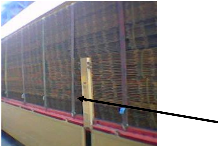
Abb. 23: Fehlendes Etikett am 2. Zurrgurt von rechts (mit Pfeil markiert)
